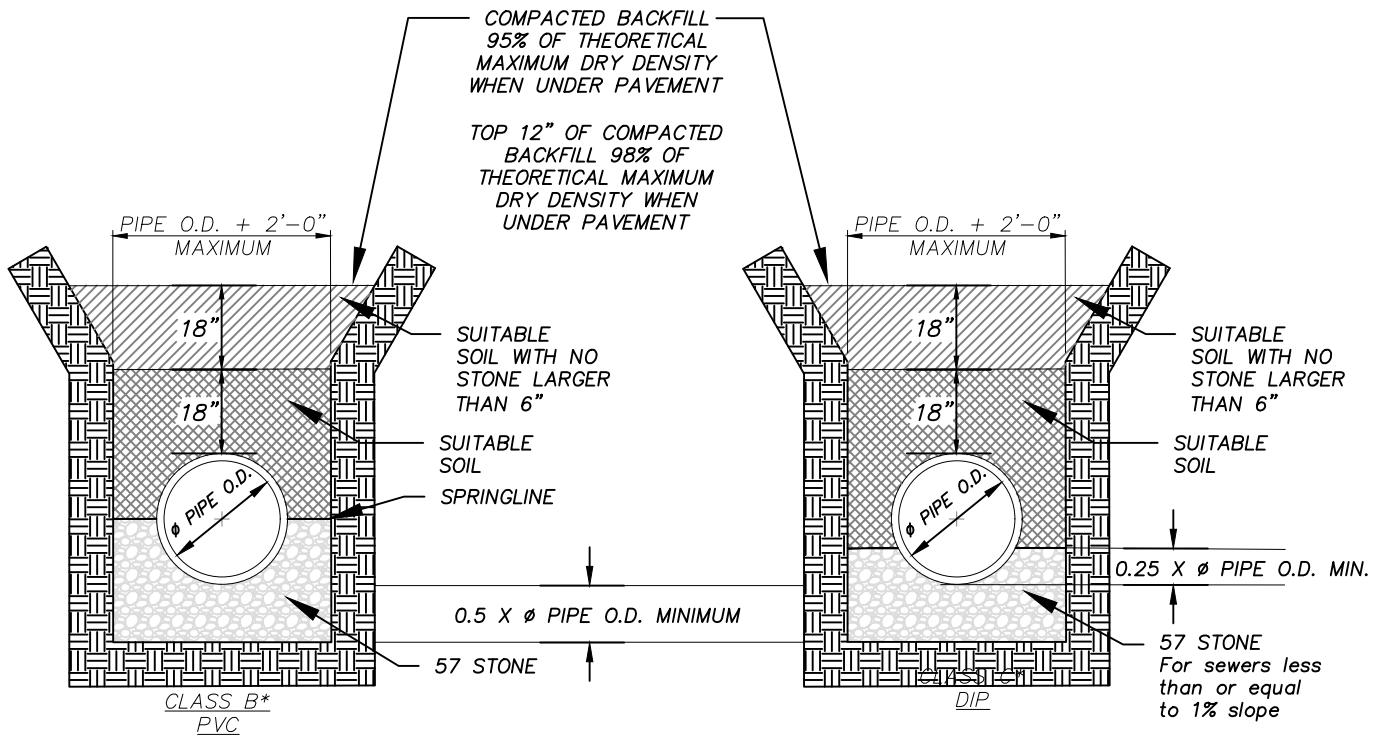
NOTE: FOR TRENCHES IN ROCK MINIMUM TRENCH WIDTH IS 3'-0" AND MINIMUM BEDDING IS 6".
