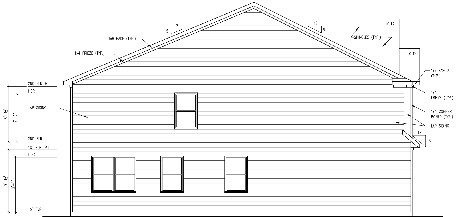
LEFT SIDE ELEVATION SCALE: 1/8" = 1'-0"
